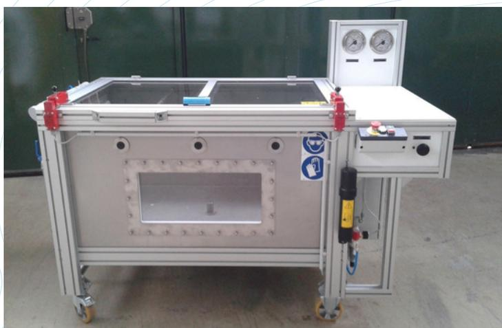
Il banco prova B\_22765 è ideato per eseguire test su masse radianti ed altri componenti. Il fluido di prova è l'aria compressa.
