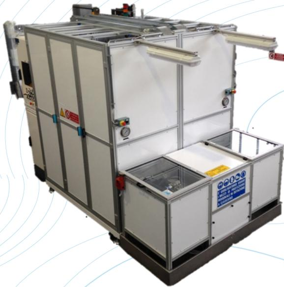
Il banco prova B\_21553 è ideato per eseguire test su masse radianti. Il fluido di prova è glicole etilenico. Il banco prova a due postazioni con i vari optional, è in grado di eseguire:
