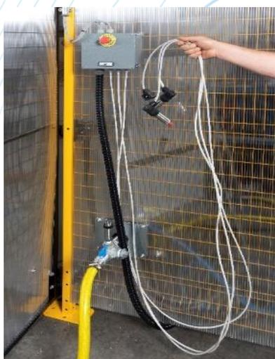
Il sistema di connessione è costituito da un tubo flessibile che veicola l'acqua al componente da testare. 3 trasduttori di pressione, con segnale acquisito, sono disponibili alla posa sul componente in test.
