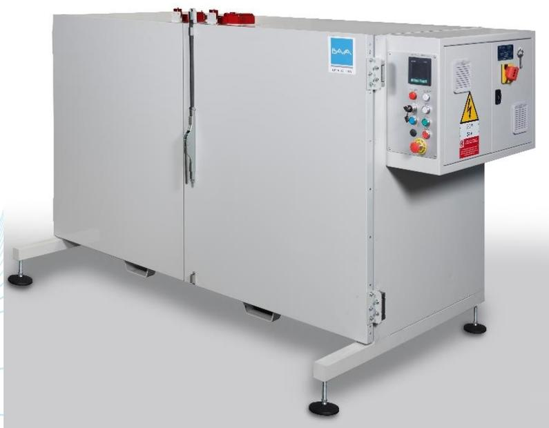
Il banco prova B\_23164 è ideato per test di irraggiamento solare simulato su vetri stratificati.
