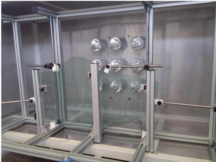
Un carrello estraibile permette il posizionamento e il riferimento del vetro a mezzo di dispositivi di supporto meccanici, in area esterna alla camera di test, per agevolare l'ergonomia di lavoro.
