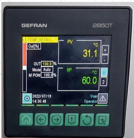
Impiegando uno specifico termoregolatore PID, a 4 zone di controllo, la macchina permette la definizione completa di un ciclo termico di test impostabile liberamente da operatore.
