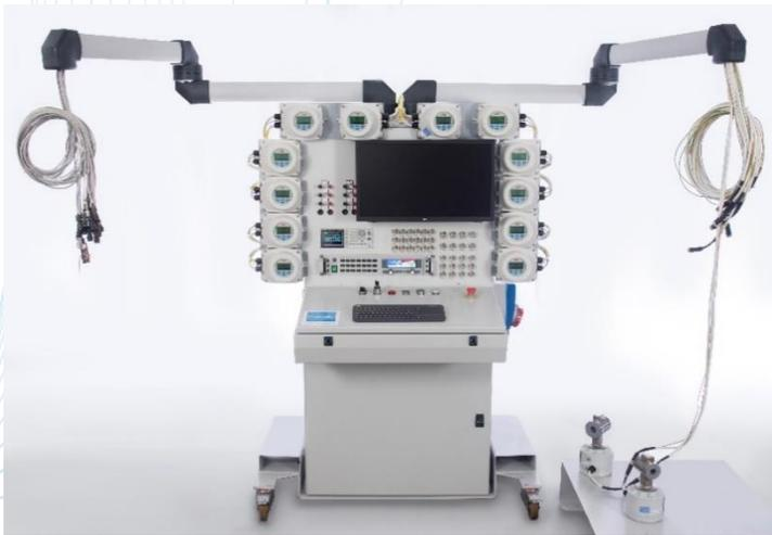
La stazione di test B\_23092 è costruita per la misura dei parametri idraulici del sistema di raffreddamento del gruppo propulsore di veicoli termici, ibridi e/o elettrici.
