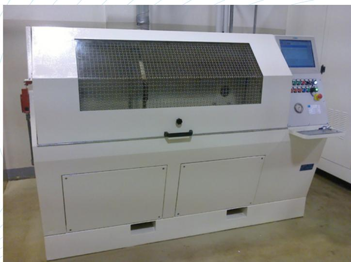
Il banco prova B\_21472 è ideato per test su componenti come tubazioni flessibili o rigide, raccordi, innesti rapidi, valvole, masse radianti ecc. Il fluido di prova è olio idraulico.
