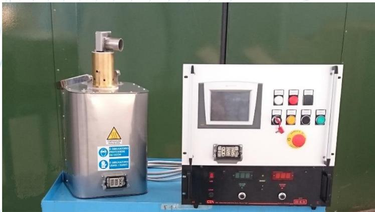
Il generatore di vapore metabolico B\_22186 è progettato per simulare la presenza di un numero variabile di persone all'interno di un abitacolo.
